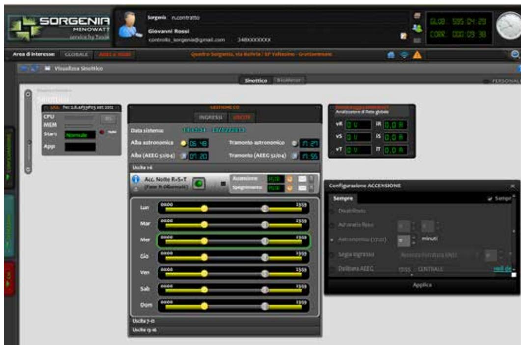
La possibilità di comunicare facilmente con l'apparato DIBA-TL consente al Gestore dell'impianto, direttamente via web, di variare a piacimento ed in maniera dinamica le configurazioni dei cicli di accensione.
